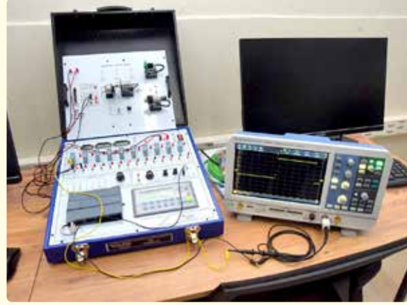
PLC ile Sensör Deneyi: PLC ile optik, kapasitif ve endüktif sensörlerin kullanılması ile ilgili pratik sağlanıyor. Bu sistem, örneğin bir bant üzerinden geçen ürünlerin sayılması için kullanılıyor.
