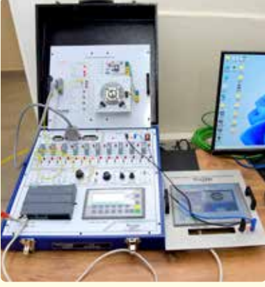
PLC ve Touch Screen Deneyi: Dokunmatik ekran üzerinden step motorun ileri geri hızlı ve yavaş çalıştırılması için yazılım uygulaması pratiği sağlanıyor.
