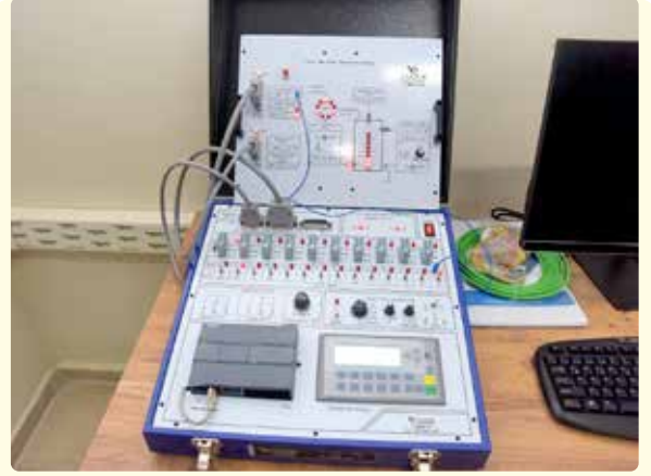
PLC ile Su Pompasının Kullanılması Deneyi: PLC kullanılarak su pompası ve depo seviyelerinin gösterilmesi gibi uygulamaların pratiğinin öğrenilmesini sağlıyor.
