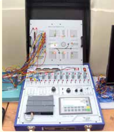
PLC ile Trafik Işıığı Deneyi: PLC ve trafik ışığı simülasyonu kullanarak trafik ışığı kontrol sistemi oluşturma sağlanıyor.
