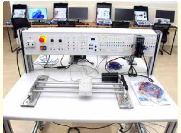
Servo Motor Deneyi: Bu deney seti ile servo motor kullanılarak istenilen kelimeler yazılabiliyor. Yazı yazabilmek için PLC üzerinden servo motor sürücüyü kod yazma işlemi bu deney ile gerçekleştiriliyor.
