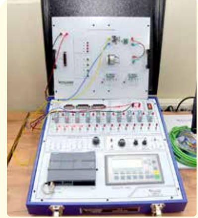
PLC ile DC Motor Deneyi: Doğru akım (DC) motorun hız kontrolünün ve devir yönü kontrolünün PLC üzerinden kontrol edilmesini sağlıyor.
